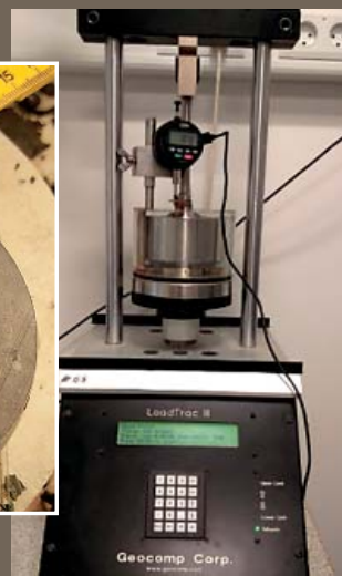
En lerprøve samt et apparat til måling af kvældetryk.
