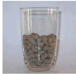
Bentonit før vandkontakt
