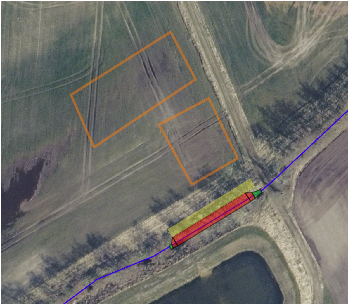
Figur 1 Udvidelse af sandfang. Grøn markering: sikring med sten, samme kote som regulativmæssig bund. Rød markering: udvidelse af sandfang til bredde 3,5 m, længde 30 m, 1,0 m under regulativmæssig bund. Brinkanlæg 1:1. Gul markering: afgravning af tidligere oplæg, tykkelse 0,3 – 0,5 m. Orange markering: planering af op- og afgravet jord.
