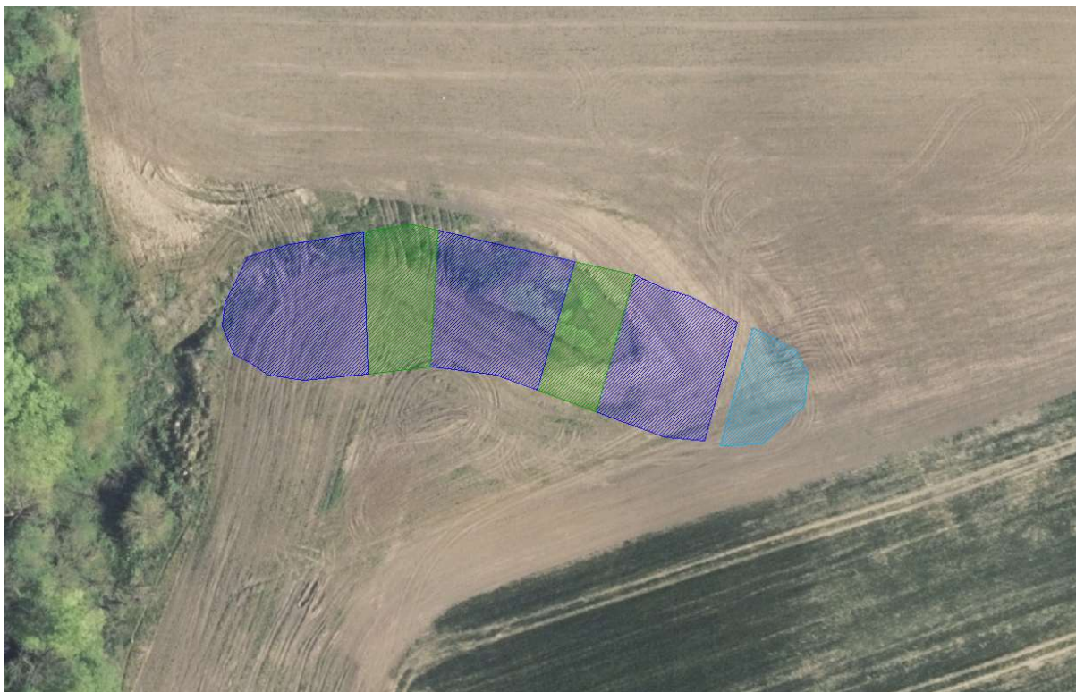
Figur 3. Udformning af minivådområdet. Dybvandsbassiner (dybde: 1 m) er vist med mørkeblå markering og lavvandsbassiner (dybde: 0,3 m) er vist med grøn markering.
