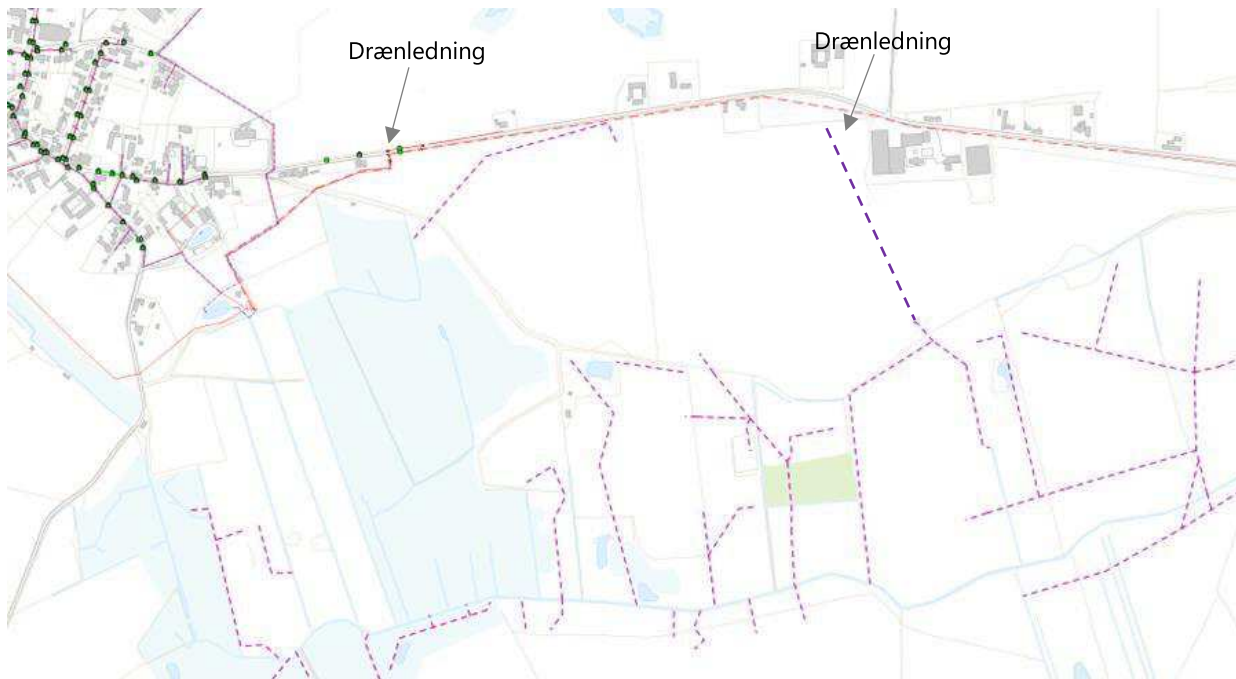
Figur 2 Drænkort modtaget af Randers Kommune med markering af eksisterende drænledninger, som planlægges tilsluttet ifm. afvanding af vejprojekt. Mørkelilla stiplede linje er indtegnet i hånden.
