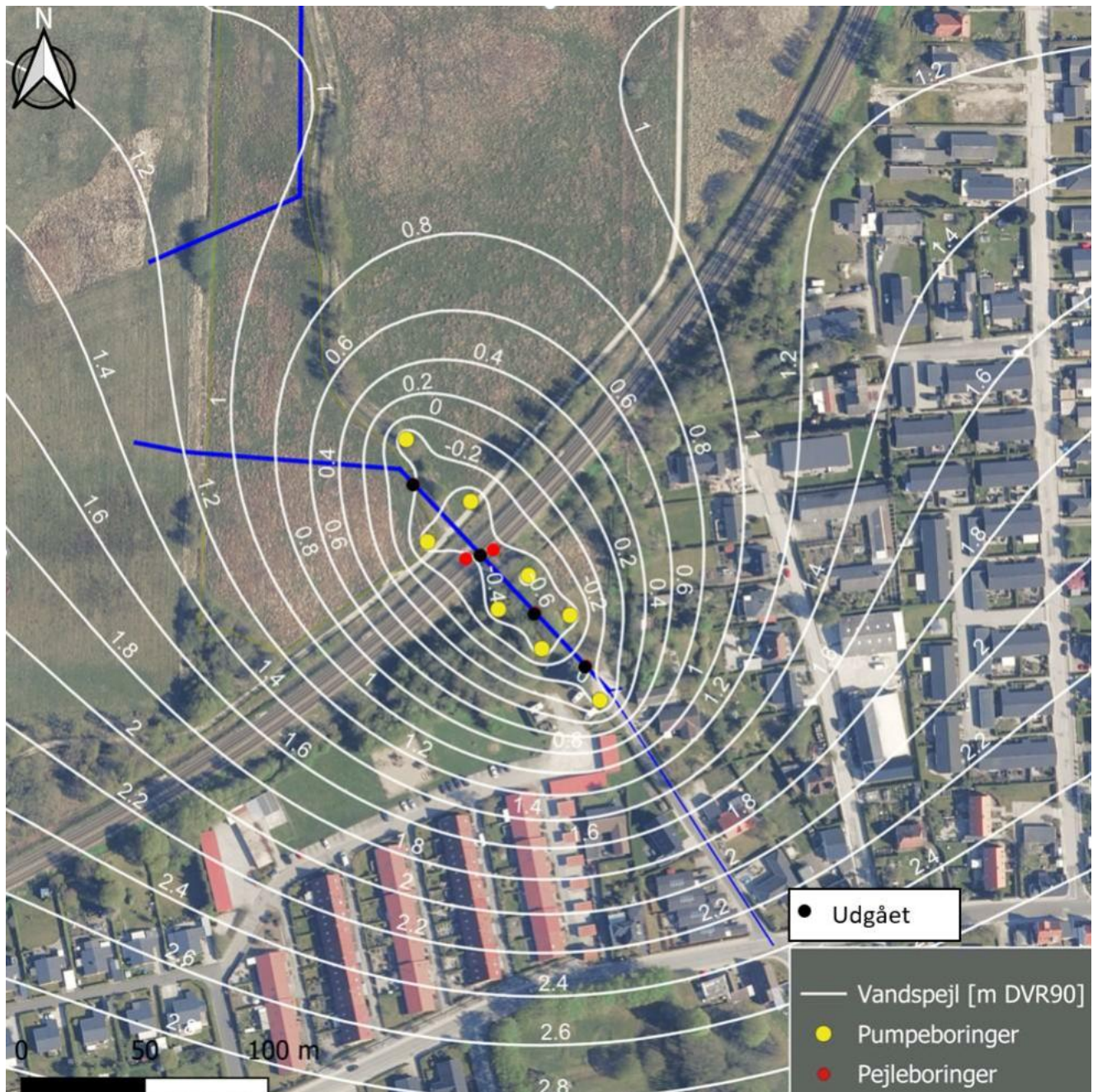
Figur 5: Simuleret grundvandsstand efter 30 dage med grundvandssænkning jf. beskrivelsen ovenfor. Projektet har tilrettet pejleboringer, og i stedet pejles der i de to udførte borer i sporet.
