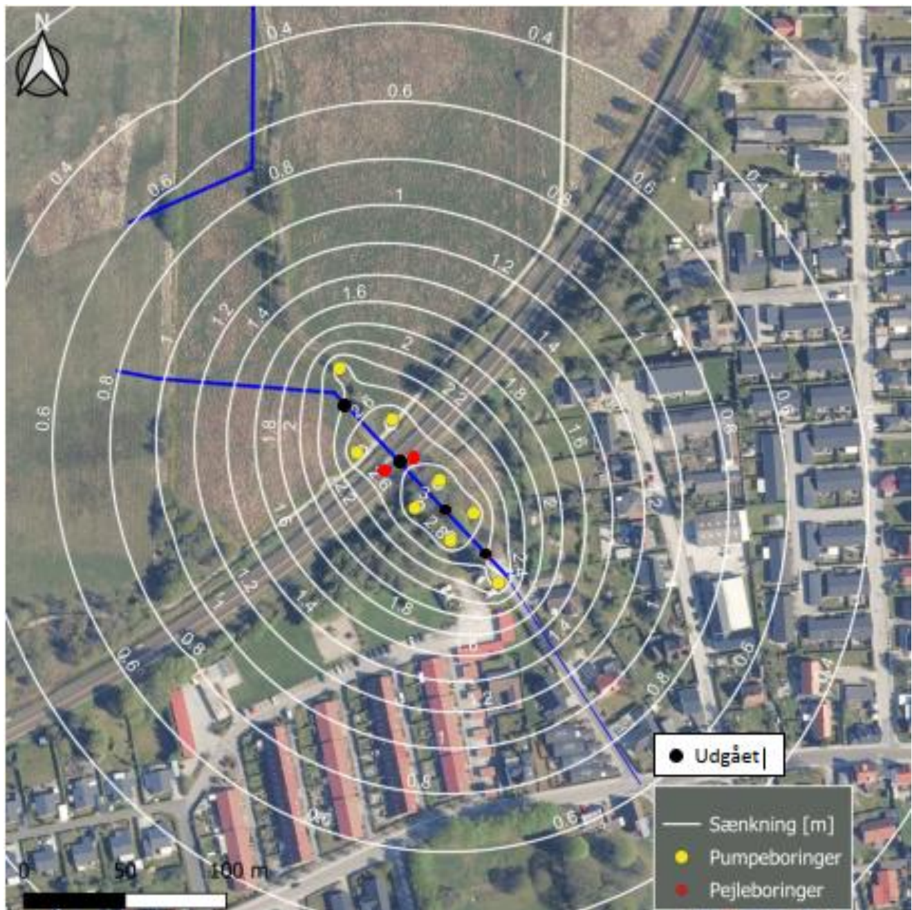
Figur 6: Udbredelse af sænkning efter 30 dage med grundvandssænkning jf. beskrivelsen ovenfor. Projektet har tilrettet pejleboringer, og i stedet pejles der i de to udførte boringer i sporet.
