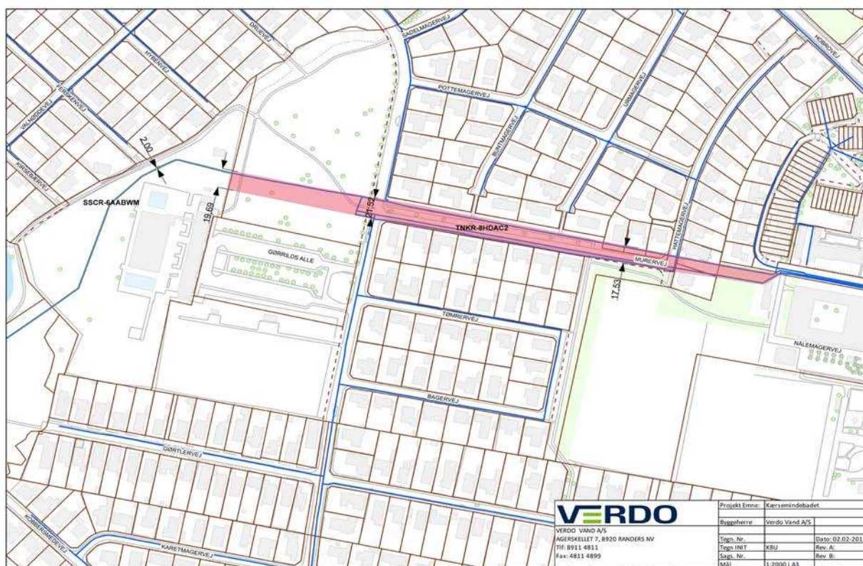
Figur e: Tinglyst vandledning med beskyttelseszone.
