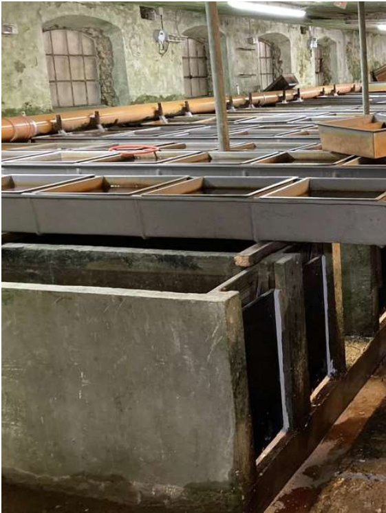
Figur 3: indretning i kummehus med klækkerbakker til æg og kummer til yngel nedenunder.
